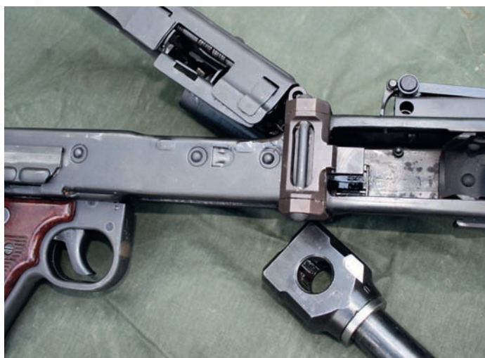
Im Gehäuse angebrachte Nieten verhindern den Gebrauch von Militärläufen im M 42. Die Kimme ist hier abgeklappt.
