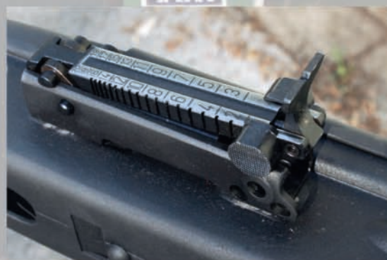
Über den Visierschieber lässt sich das Visier auf Schussweiten bis zu 2000 Meter einstellen. Die Kimme kann abgeklappt werden.
