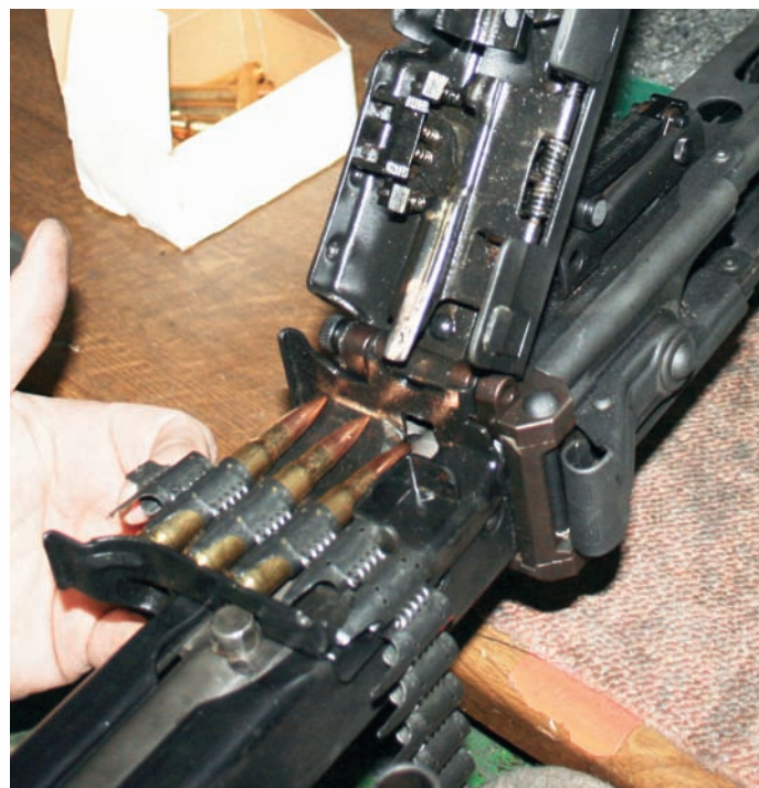
Der längliche Transporthebel des Zuführeroberteils muss vor Schussabgabe zur linken Seite des Gehäusedeckels weisen.
