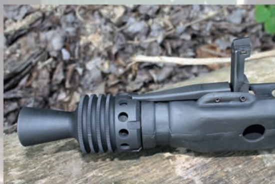
Die Sperre zum Rückstoß-Verstärker hält diesen in Position. In dem aufklappbaren Kornträger sitzt das Korn des M 42.
